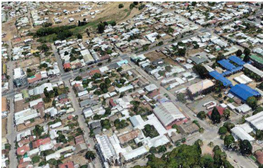
FIGURA 7-10 NUBE DE PUNTOS DENSA
